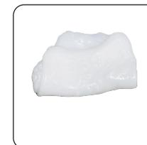
※本品は上図のように、熱湯を加えてジェル状になったり、そのまま冷めていくことで固化するのを繰り返します。接着するのはこの固化する過程の中でくっつけていきます。この性質を利用して接着のやり直しや繰り返しの使用ができるようになっています。
